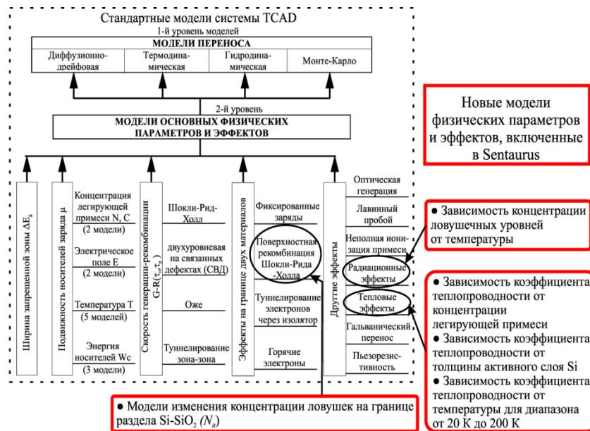
Рис. 1.3. Новые температурные модели, встроенные в Synopsys TCAD, учитывающие нейтронное, протонное и гамма облучение
